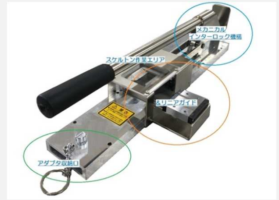
CPUをスムーズにセット・割割・簡単排出（操作レバーを左右に振る）
