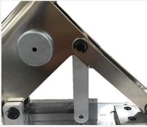
レバー操作を止める安全機構を搭載
